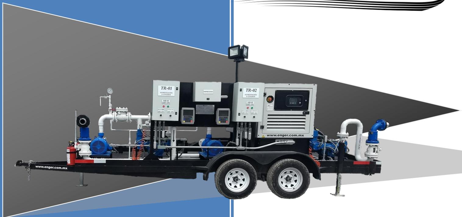
EQUIPO PARA TRANSVASE DE CARROTANQUE A PIPAS DE COMBUSTIBLE (DIÉSEL Y GASOLINA) CON CAPACIDAD DE 900 LPM EN 3" Y 1200 LPM EN 4"
